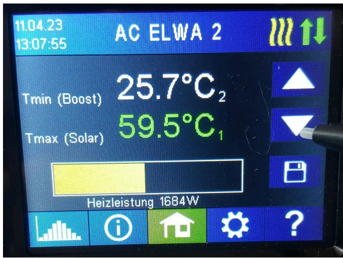
Um die Zieltemperatur für Heizen mit PV-Überschuss einzustellen, tippen Sie auf die untere Temperaturanzeige Tmax (Solar) und verwenden die Pfeiltasten rau auf und runter am rechten Bildschirmrand. Danach speichern Sie die Einstellungen mit dem Button darunter.
